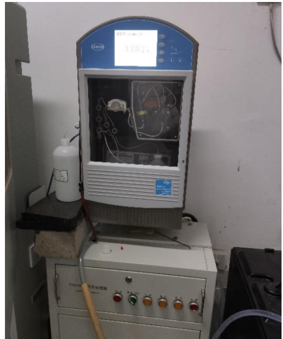
出口氨氮水质自动分析仪
