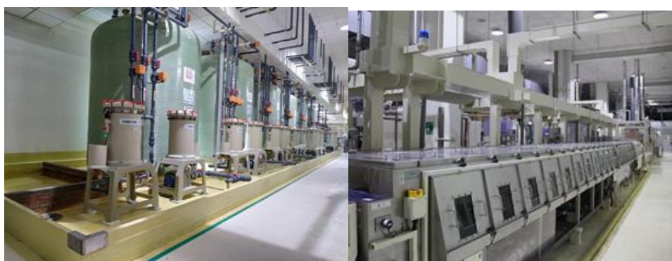
图 4 生产线围堰
