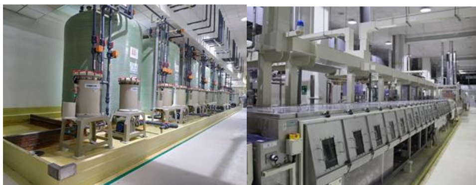
图 4 生产线围堰
