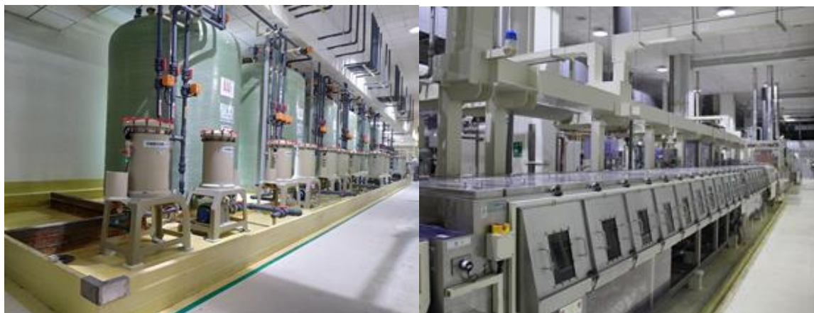
图 3-13 生产线围堰
