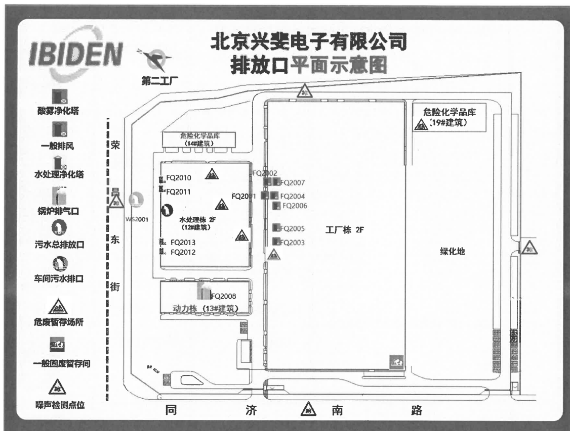
第二工厂 废水、废气排放口平面示意图
