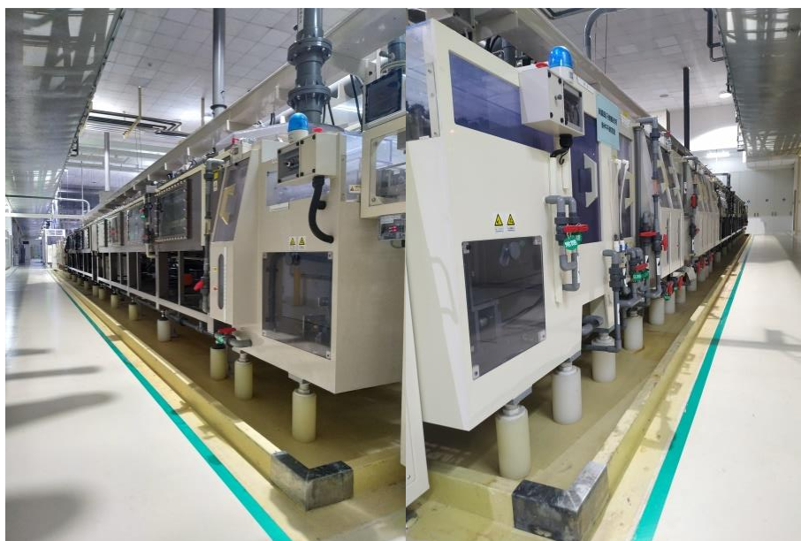
图 4-5 生产线药液罐防液堤（2）
