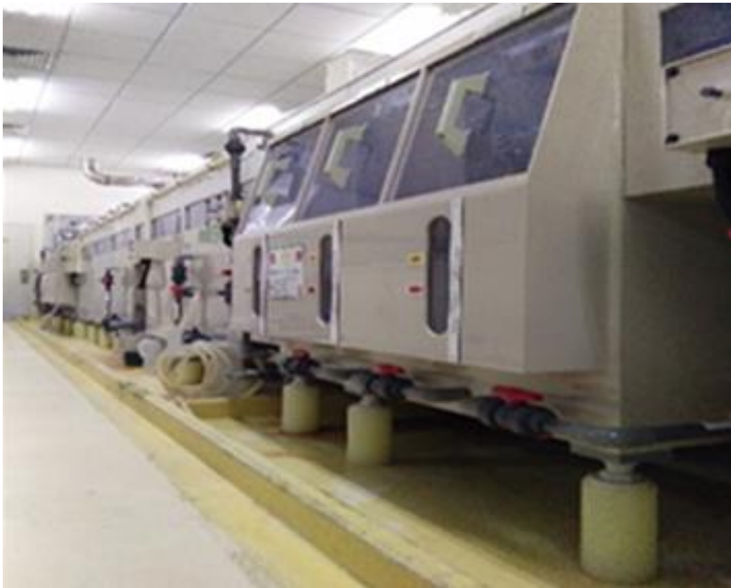
图 4-6 架空生产线及环氧树脂地面+围堰
